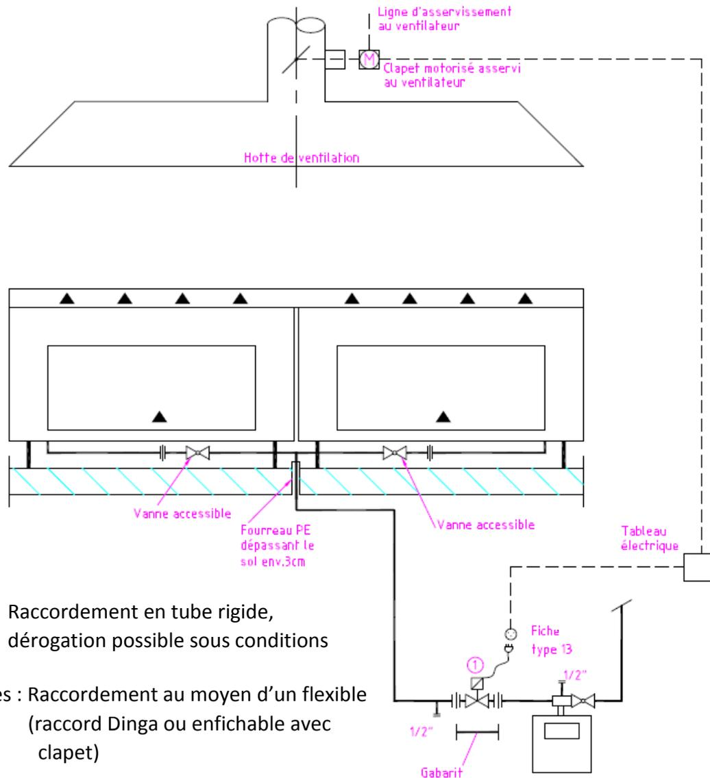
Appareils fixes : Raccordement en tube rigide, dérogation possible sous conditions
