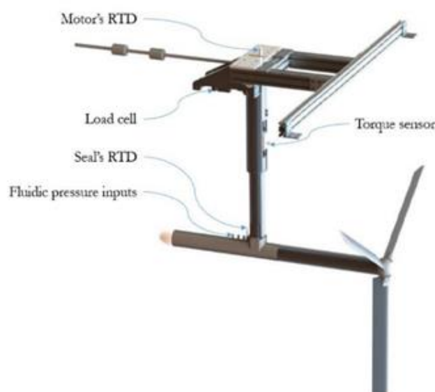
Fig. 1 Système mécanique conçu et fabriqué à l'HEPIA permettant l'injection d'air, à travers le moyeu en rotation, dans les oscillateurs fluidiques se trouvant au niveau des pâles.
